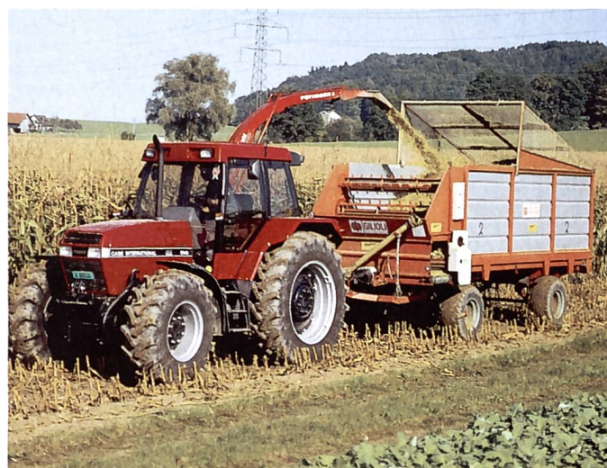
Die Flächenleistung eines Anbaumaishäckslers hängt in erster Linie von der Motorleistung des Traktors ab. Bei genügend starken Traktoren können Anbaumaishäcksler sehr konkurrenzfähig sein.
