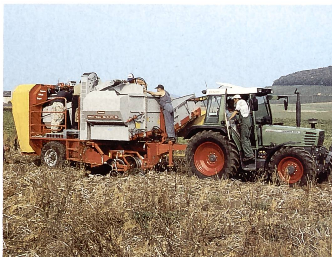
Der zweireihige Kartoffelvollernter ist sehr leistungsfähig. Er lässt sich jedoch nur bei Erntedämmen mit wenig Steinen und Schollen wirtschaftlich einsetzen.
