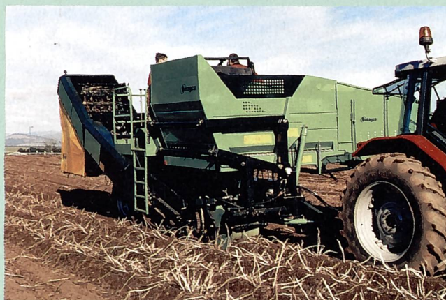
Netagco-Wühlmaus: einreihiger Seitenroder Typ 1833 mit 4-Tonnen-Rollbodenbunker.
