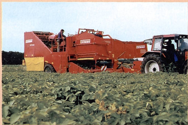
Grimme: zweireihiger Vollernter mit 6-Tonnen-Rollbodenbunker.
