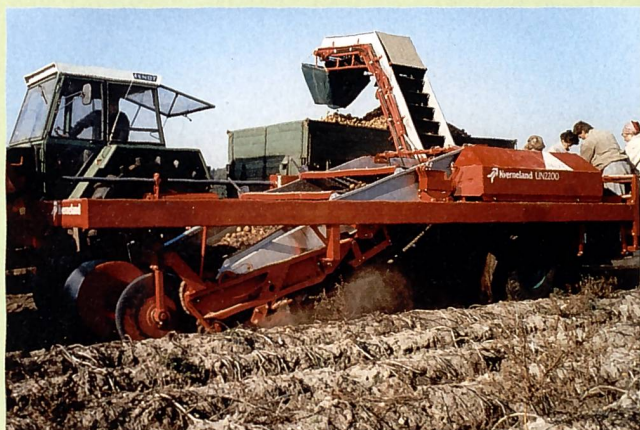
Kverneland UN 2200: zweireihiger Kartoffelernter mit Überladeband, ausgerüstet mit einer hydraulischen Radlenkung.
