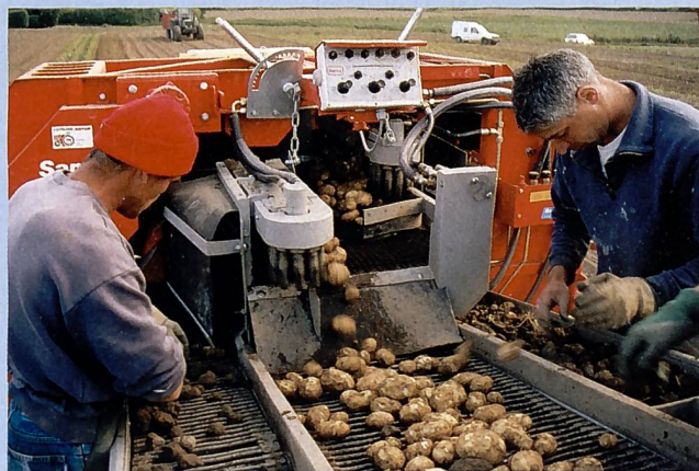
Der Offset 2000 basiert auf der Baureihe Offset 97. Er hat ein breiteres Krautband, eine längere Siebkette und einen Rollbodenbunker, der mit 4 t bis auf 3,80 m entleerbar ist.
