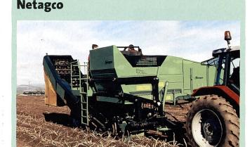
Netagco-Wühlmaus: einreihiger Seitenroder Typ 1833 mit 4-Tonnen-Rollbodenbunker.
