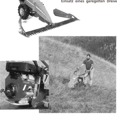
Abb.1: Der Motormäher ist in der Schweiz mit 82 000 Einheiten, neben dem Traktor, die häufigste mit einem Verbrennungsmotor betriebene Landmaschine. Bei deren Einsatz bewegt sich die Bedienungsperson direkt in den mit giftigen Komponenten angereicherten Abgasen.
