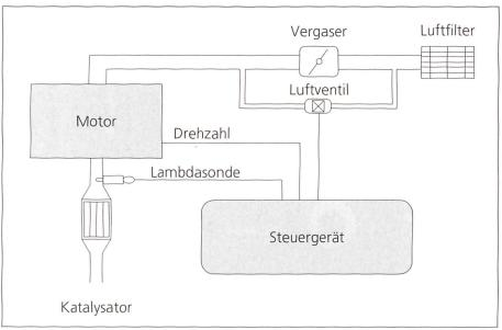
Abb. 6: Geregeltes Dreiwege-Katalysatorsystem für Benzinmotoren mit Vergaser-Gemischaufbereitung.
