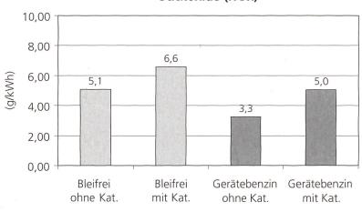
Abb. 10: Einfluss der Benzinart und des geregelten Dreiwege-Katalysators aufdie Emissionsfaktoren im Prüfzyklus ISO 8178-G1.
