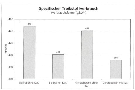
Abb. 11: Der spezifische Treibstoffverbrauch sinkt hauptsächlich wegen der Lambda-Regelung des Katalysatorsystems.
