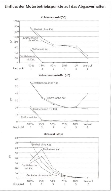
Abb. 9: Die Wirkung verschiedener Massnahmen auf die emittierten Motorabgase hängt auch sehr vom Motorbetriebspunkt ab.
