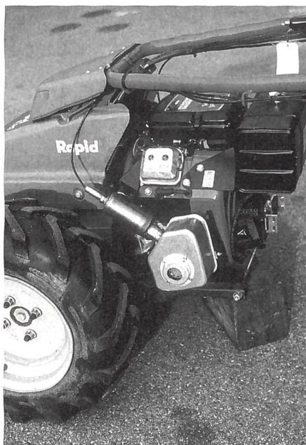
Abb. 7: Der Abgaskatalysator mit eingeschraubter Lambdasonde ist dem serienmässigen Schalldämpfer vorgeschaltet. Die Abgase sollen den Katalysator möglichst direkt ohne vorherige Abkühlung passieren.
