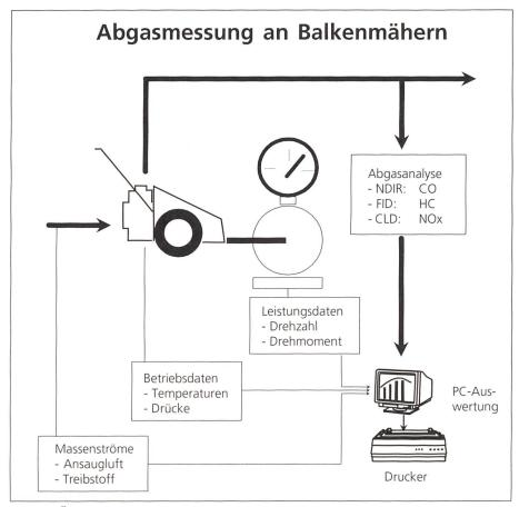
Abb. 5: Übersicht über die Prüfstandsanordnung zur Untersuchung der Motorabgase an Motormähern.
