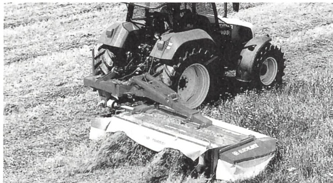
Pöttinger NovaCat mit Breitstreueinrichtung für schonendere Futterernte.
