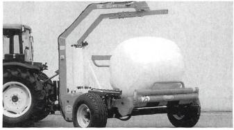
Bucher Landtechnik bringt den neuen Vicon Ballenwickler BW 1700 mit Computersteuerung auf den Markt. Das patentierte Ladesystem hebt den Ballen in der Fahrichtung der Presse ohne Gegengewicht hoch. Dank dem niedrigen Schwerpunkt und der optimalen Gewichtsverteilung erreicht der Vicon Ballenwickler eine hohe Stabilität bei gleichzeitig geringem Eigengewicht von nur 680 kg.
