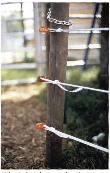
UV-beständige Isolatoren und zweckmässige Klemmen garantieren die nötige elektrische Spannung am Zaundraht auf seiner ganzen Länge.
