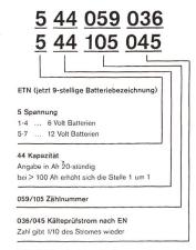
Mit ETN wird im Rahmen der europäischen Harmonisierung die Batteriebezeichnung nach DIN abgelöst.
