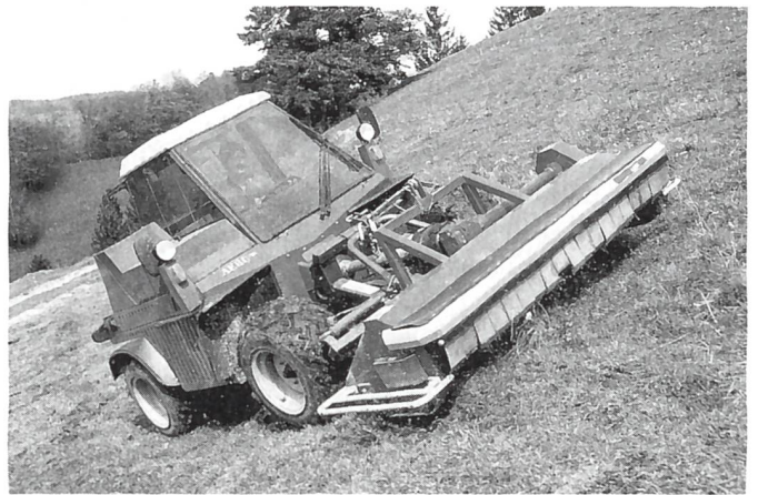
Der neue (Hang-)Geräteträger und Mehrzweck-Traktor Terratrak Aebi TT95, ausgerüstet mit einem leistungsfähigen 82-PS-Turbodiesel und 40-km/h-Getriebe.
