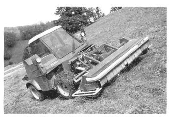
Der neue (Hang-)Geräteträger und Mehrzweck-Traktor Terratrac Aebi TT95, ausgerüstet mit einem leistungsfähigen 82-PS-Turbodiesel und 40-km/h-Getriebe.
