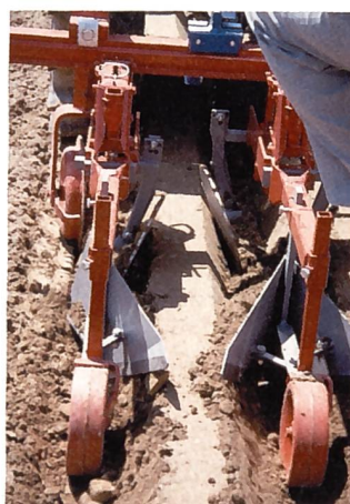
Spezielles Dammerbackgerät von Bärtschi FOBRO, das in einem Arbeitsgang mit zwei Scheiben die Dämme vom Unkraut befreit und sie mit Häufelkörpern wieder aufbaut.
