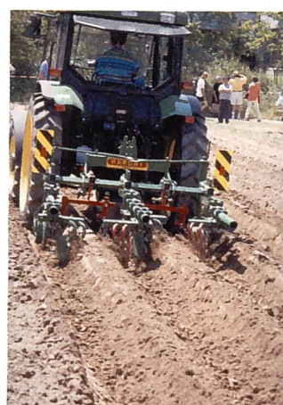
Mit dem Sternbackgerät, das sowohl weg- als auch anhäufelt, können die Dämme wirkungsvoll bearbeitet werden.
