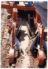
Spezielles Dammbackgerät von Bärtschi FOBRO, das in einem Arbeitsgang mit zwei Scheiben die Dämme vom Unkraut befreit und sie mit Häufelkörpern wieder aufbaut.
