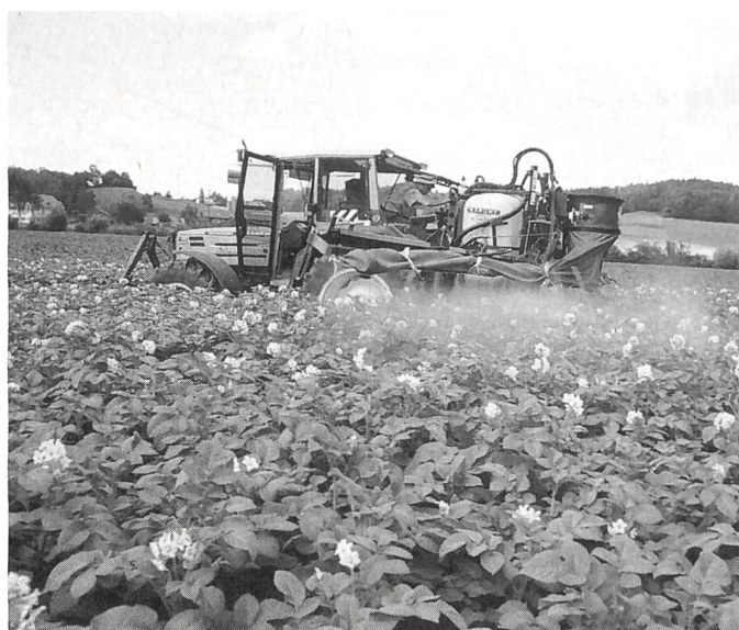
Abb. 1: Im dichten Bestand liess sich die Krautfäule mit 400 l/ha Brühemenge bei 7 bar Druck und 5 km/h Fahrgeschwindigkeit verhindern. Rechts: Fahrgassen ermöglichen ein rechtzeitiges Spritzen und eine breitere Befahrung.
