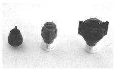
Abb. 3: Die Fortschritte der Düsentechnik tragen zur Verbesserung der Spritztechnik und Umweltschonung bei. V.l.n.r.: Flachstrahldüsen (Hardi), Injektor- Einzelund Doppeldüsen (Agrotop von U. Wyss, Bützberg).
