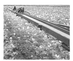
Abb. 5: Injektordüsen erzeugen luftgefüllte Blasentropfen, die durch den Druck (9 bar) beschleunigt, tief in den Bestand eindringen. Links/rechts: Einzel-/Doppel-Flachstrahl-Injektordüsen.
