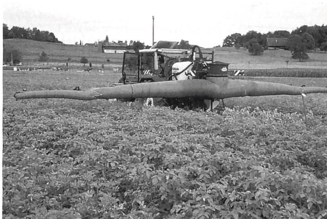
Abb. 2: Mit Luftunterstützung durch ein Axialgebläse wird die Bestandesdurchdringung verbessert und die Abtrift reduziert.
