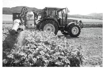
Abb. 2: Mit Luftunterstützung durch ein Axialgebläse wird die Bestandesdurchdringung verbessert und die Abtrift reduziert.
