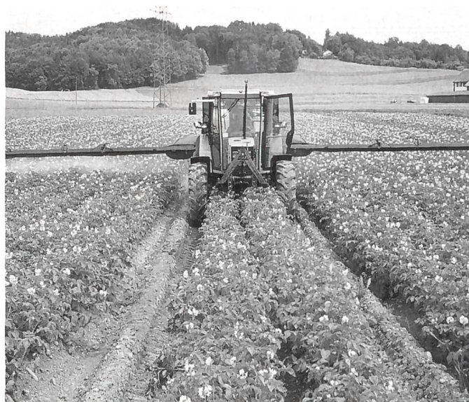
Abb. 1: Im dichten Bestand liess sich die Krautfäule mit 400 l/ha Brühemenge bei 7 bar Druck und 5 km/h Fahrgeschwindigkeit verhindern. Rechts: Fahrgassen ermöglichen ein rechtzeitiges Spritzen und eine breitere Befahrung.
