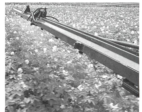
Abb. 5: Injektordüsen erzeugen luftgefüllte Blasentropfen, die durch den Druck (9 bar) beschleunigt, tief in den Bestand eindringen. Links/rechts: Einzel-/Doppel-Flachstrahl-Injektordüsen.
