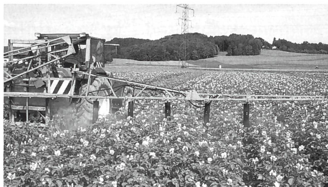
Abb. 6: Mit der Unterblattspritzeinrichtung wurden die Blätter und Stengel von jeweils zwei unten platzierten Düsen pro Element und von oben recht gleichmässig behandelt (Prototyp).
