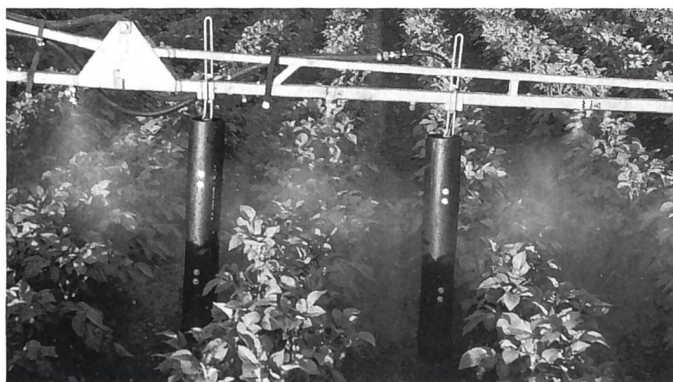
Abb. 6: Mit der Unterblattspritzeinrichtung wurden die Blätter und Stengel von jeweils zwei unten platzierten Düsen pro Element und von oben recht gleichmässig behandelt (Prototyp).
