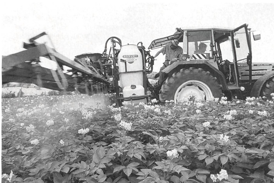
Abb. 5: Injektordüsen erzeugen luftgefüllte Blasentropfen, die durch den Druck (9 bar) beschleunigt, tief in den Bestand eindringen. Links/rechts: Einzel-/Doppel-Flachstrahl-Injektordüsen.
