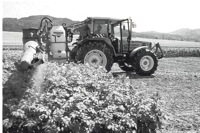
Abb. 2: Mit Luftunterstützung durch ein Axialgebläse wird die Bestandesdurchdringung verbessert und die Abtrift reduziert.
