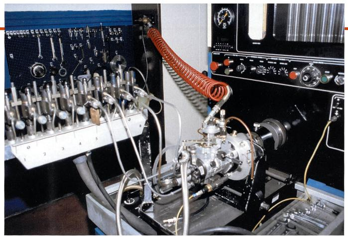
Eine Lucas-Diesel-Einspritzpumpe wird auf Herz und Nieren geprüft.
