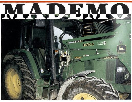
Dank kompakter Kupplungsbox für sämtliche Ölanschlüsse braucht es nur wenige Handgriffe für den Wechsel von der Zugzur Arbeitsmaschine «Traktor».
