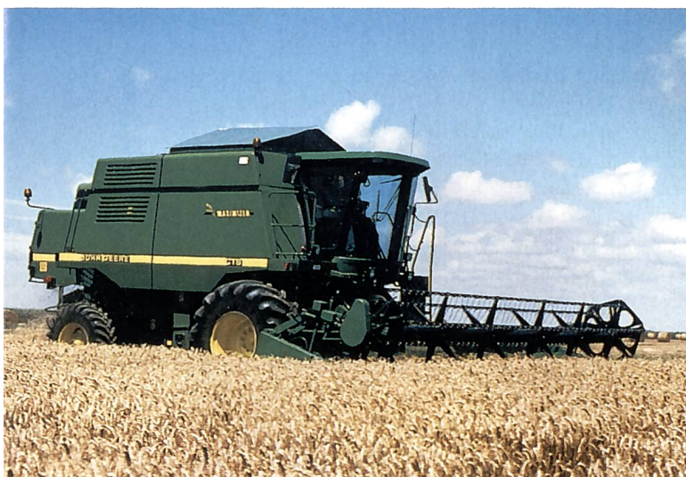
CTS mit 660 mm Dreschtrommeldurchmesser und zahlreichen Detailverbesserungen.
