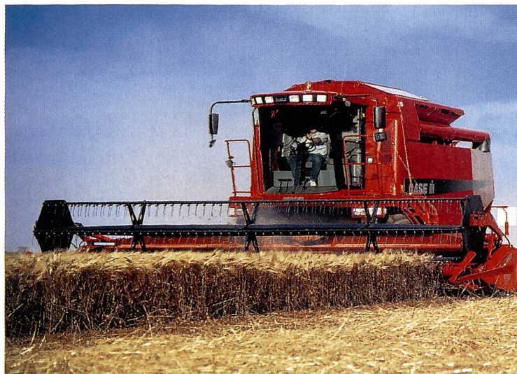
CF 80 (Cross-Flow) mit Intensiv-Dreschwerk, 6 Schüttlern und 300 PS Motorleistung.
