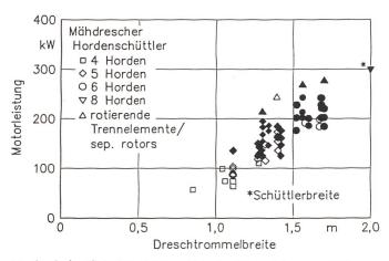
Die durchschnittliche Motorleistung ist in den letzten Jahren um 20% gestiegen. Dies läuft parallel zur Zunahme der Anzahl Hordenschüttler, die in den Mähdreschern eingebaut werden. Im oberen Leistungsbereich steigt die Anzahl der Typen mit rotierenden Trennelementen.
