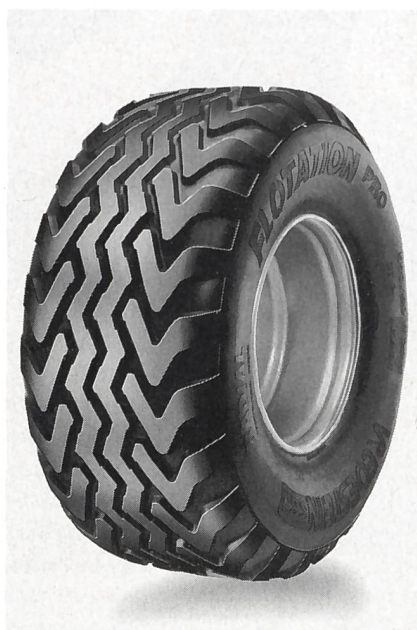
Neue Generation Implement-Reifen Flotation Pro von Vredestein mit Radialkarkasse, zum ersten Mal ausgestellt an der AGRAMA, ausgelegt auf ein hohes Transportgewicht bei hoher Geschwindigkeit und doch relativ tiefem Luftdruck. Die hier angewendete Radialbauweise mit einem stabilen Gürtel bringt einen geringen Rollwiderstand und schützt vor Reifenbeschädigungen durch Steine.
