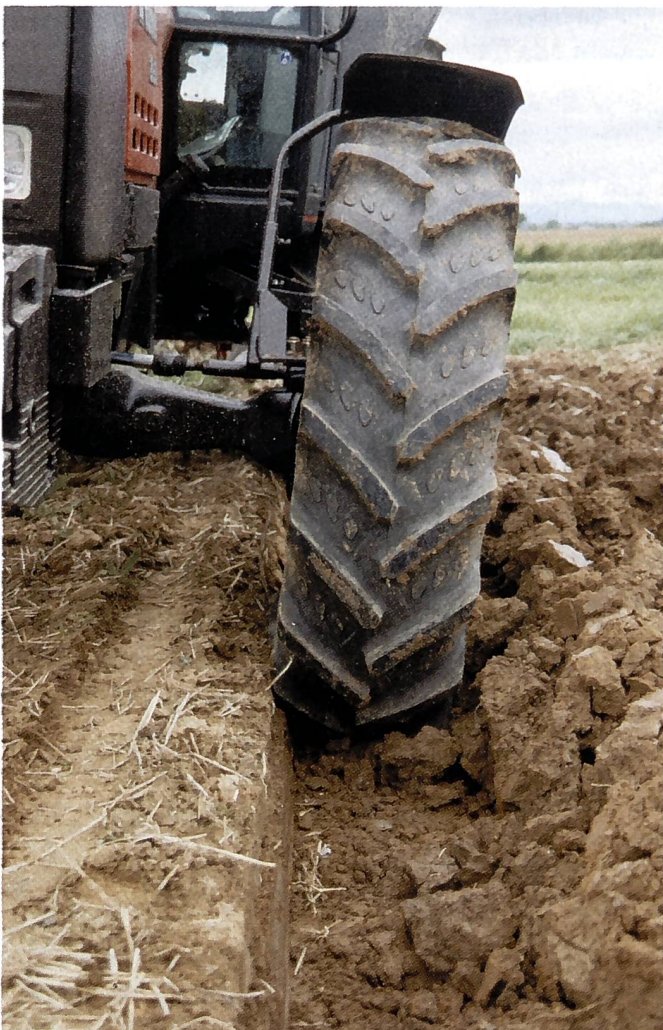
Ein Kleber-Acker-Profil dreht durch die Pflugfurche. Beim schmalen Reifen verringert der grosse Reifenumfang den spezifischen Bodendruck und den Rollwiderstand.
