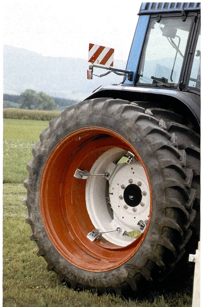
Die Doppelbereifung bzw. Breitereifung ist für landwirtschaftliche Fahrzeuge zulässig bis zur Gesamtbreite von 2,55 Metern.
