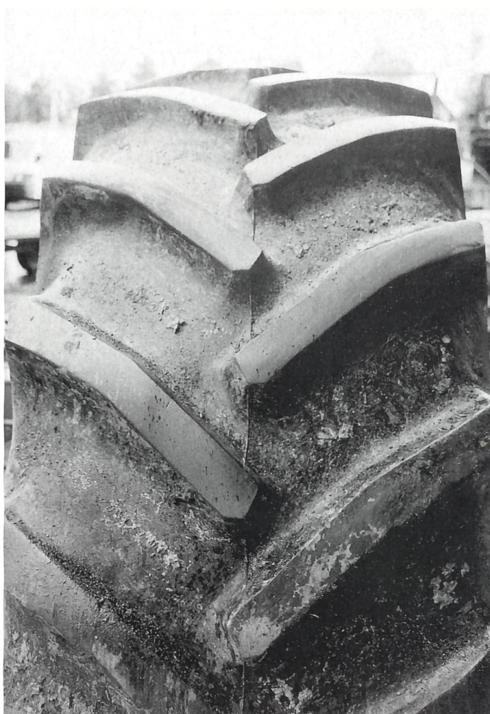
Typisches Schadbild: Zu stark gepumpter Reifen führt zur starken Abnutzung in der Reifenmitte.
