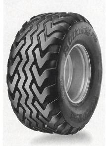
Neue Generation Implement-Reifen Flotation Pro von Vredestein mit Radialkarkasse, zum ersten Mal ausgestellt an der AGRAMA, ausgelegt auf ein hohes Transportgewicht bei hoher Geschwindigkeit und doch relativ tiefem Luftdruck. Die hier angewendete Radialbauweise mit einem stabilen Gürtel bringt einen geringen Rollwiderstand und schützt vor Reifenbeschädigungen durch Steine.
