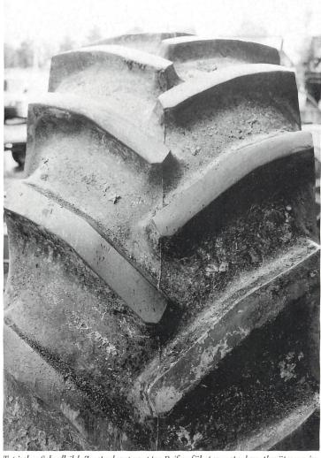
Typisches Schadbild: Zu stark gepumpter Reifen führt zur starken Abnützung in der Reifenmitte.
