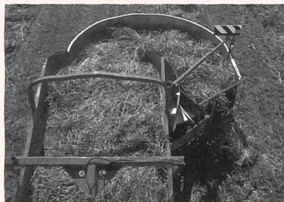
Abb. 12: Die Einstellung der Maschine ist so zu optimieren, dass das Gummiförderband und der Wendetisch möglichst gleichmässig beschickt werden.
