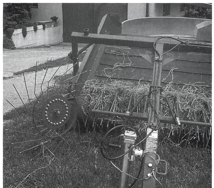
Abb. 9: Das vor dem Pick-up angebrachte Sternrad verhindert grössere Aufnahmeverluste, wenn Schwade mit einer Breite von über 120 cm geformt werden.
