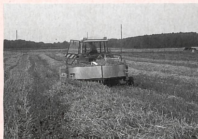
Abb. 14: Obwohl grundsätzlich für den Futterbau konzipiert, kann der Schwadwender für eine verbesserte Auslastung auch zum Strohwenden eingesetzt werden. Allerdings funktioniert es nur, wenn die Strohmaden nicht zu dick sind.
