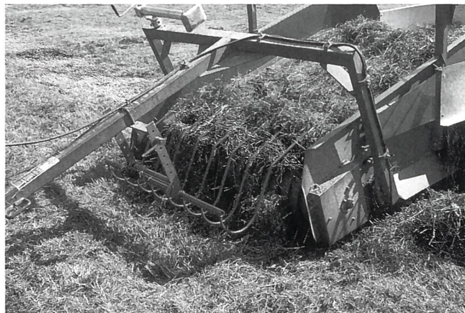
Abb. 2: Der Niederhalter über dem Pick-up hat die Aufgabe, dass das Futter schonend und gleichmässig auf das Förderband gelangt.
