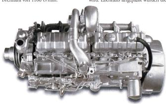
Die Drehzahl wurde so um 28% (rund 400 U/min) gegenüber den üblichen Drehzahlen bei Standard-Traktoren gesenkt. Diese Massnahme hat laut Valtra zur Folge, dass der Treibstoffverbrauch um 5 bis 10% sinkt und sich die Wartungs- und Ölwechselintervalle von 250 auf 500 Stunden erhöhen.
