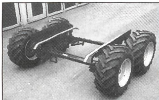
Kurmann-Bogie Tandemaggregat für Tiefgang-Ladewagen und spez. Anhänger, starr oder gelenkt
