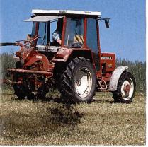
Elektrisch oder hydraulisch bedienter Gülleverteiler an der Dreipunkt-Hydraulik sichert eine gute Gülleverteilung.
