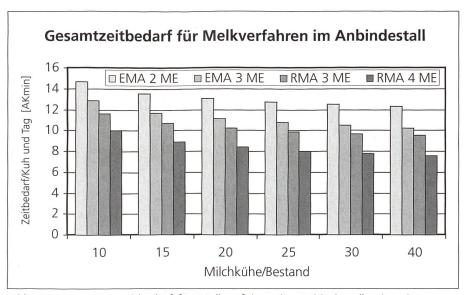
Abb. 8: Der Gesamtzeitbedarf für Melkverfahren im Anbindestall zeigt ein grosses Einsparungspotenzial durch verbesserte technische Ausstattung auf.
