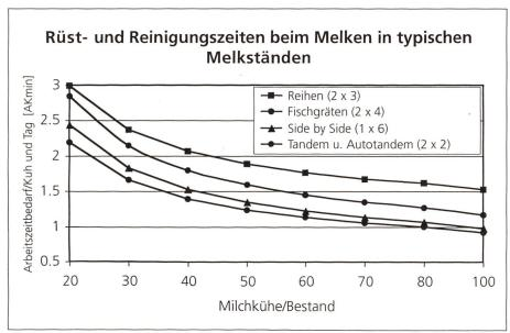
Abb. 6: Im Melkstand hängen die Rüst- und Reinigungszeiten vorwiegend von der Anzahl Melkeinheiten ab.
