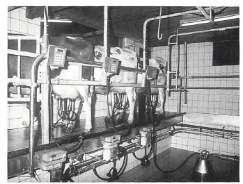
Abb. 14: Der Fischgrätenmelkstand kombiniert platzsparende Anordnung, relativ kurze Wege und gute Übersicht über die Euter der Kühe.
