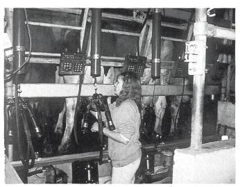
Abb. 15: Im Side by Side-Melkstand ist die Übersicht über die Euter nicht optimal. Dafür sind die Wege sehr kurz.
