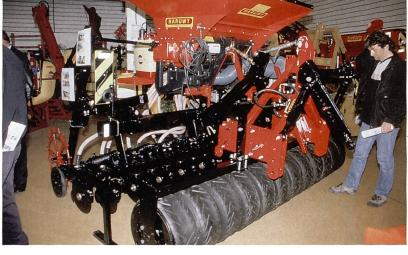
Kompakte Säkombination, exakte Tiefenführung, geringer Säreibenabstand, hohe Flächenleistung: Die moderne Sätechnik vereinigt Vorzüge der intensiven Saatbettvorbereitung und der Direktsaat.
