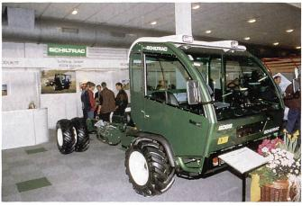
① Bei der Schiltrac Fahrzeugbau Buochs NW rückt die Problematik in den Mittelpunkt des Interesses und der Kundenorientierung. Der Konstrukteur baut seine Transporter auf einem patentierten zweiholmigen Geräterahmen auf, und der Motor ist im hinteren Chassis-Teil halbwegs unter der Fahrerkabine gelagert, so dass das Drehmoment für den Fahrantrieb
