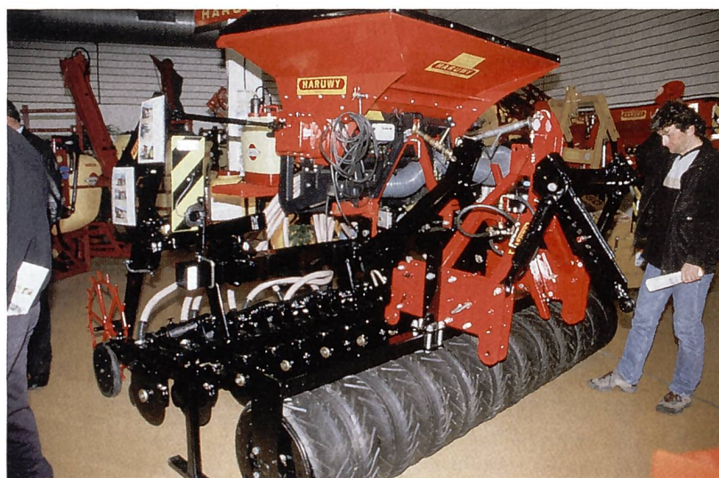
Kompakte Säkombination, exakte Tiefenführung, geringer Säreibenabstand, hohe Flächenleistung: Die moderne Sätechnik vereint Vorzüge der intensiven Saatbettvorbereitung und der Direktsaat.
