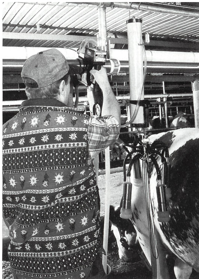
... «High-Tech»: Melksteuergerät und Melkzeug in Leichtbauweise und mit Schnellverschluss.
