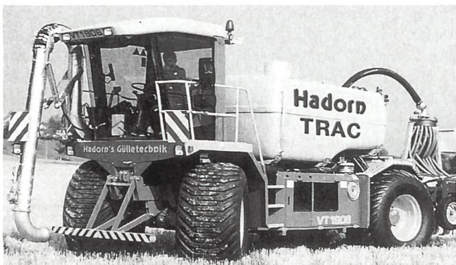
Der Hadorn-Trac transportiert 8 bis 10 m<sup>3</sup> Gülle mit 200 PS auch im Hundergang. Die übersichtliche Kabine auf den Vorderrädern ist voll klimatisiert. Der Unterflurmotor bringt den Schwerpunkt nach unten.
