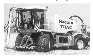
Der Hadorn-Trac transportiert 8 bis 10 m<sup>3</sup> Gülle mit 200 PS auch im Hundegang. Die übersichtliche Kabine auf den Vorderrädern ist voll klimatisiert. Der Unterflurmotor bringt den Schwerpunkt nach unten.
