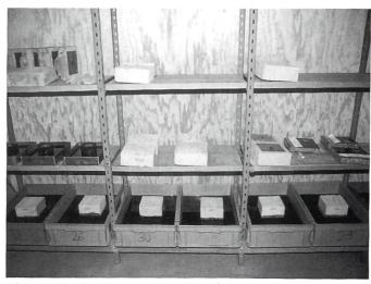
Abb. 3: Gleichzeitig zum Versuch auf der Maschine wurden Beton- und Asphaltkörper permanent in Gärsaft eingetaucht.
