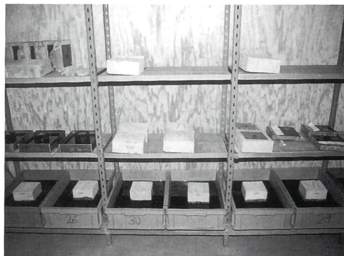
Abb. 3: Gleichzeitig zum Versuch auf der Maschine wurden Beton- und Asphaltkörper permanent in Gärtsaft eingetaucht.
