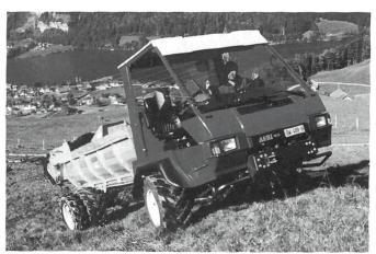
Der neue Transporter Aebi TP78 mit der einzigartigen bydraulischen Zapfwellenkupplung, einem 74 PS starken 3,3-Liter-Motor mit 23% Drehmomentanstieg sowie 16-Gang-Getriebe und enormer Nutzlast.
