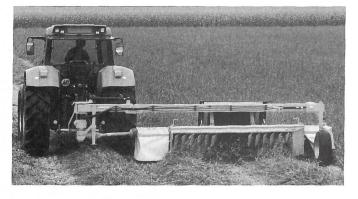
«Knautschzone» für die Rotoreinheiten entwickelt. Ein spezielles Blech wird hierfür unterhalb des Z-Profils montiert. Kommt es zum Aufprall, dann nimmt zuerst dieses Blech die Energie auf und verformt sich. Die wertvollen Getriebeeinheiten bleiben dagegen in den meisten Fällen unbeschädigt. Das Schadenrisiko wird minimiert und die Ausfallzeit begrenzt. Es stehen Mähwerke mit Arbeitsbreiten von 3,05 bis 3,75 m zur Auswahl, niit und ohne Aufbereiter.
