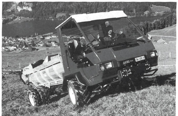
Der neue Transporter Aebi TP78 mit der einzigartigen hydraulischen Zapfwellenkupplung, einem 74 PS starken 3,3-Liter-Motor mit 23% Drehmomentanstieg sowie 16-Gang-Getriebe und enormer Nutzlast.
