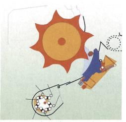
Kurvenbahngesteuerte Vierfachförderschwinge (links) und Förderrotor mit acht spiralförmig angeordneten Zinkenreihen (rechts).
