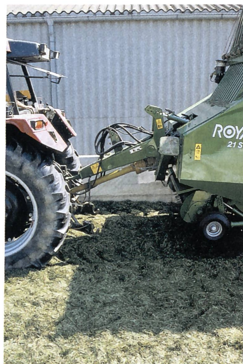
Mit einer Knickdeichsel ausgerüstete Silierladewagen lassen sich Probleme beim Befüllen des Flachsilos vermeiden.
