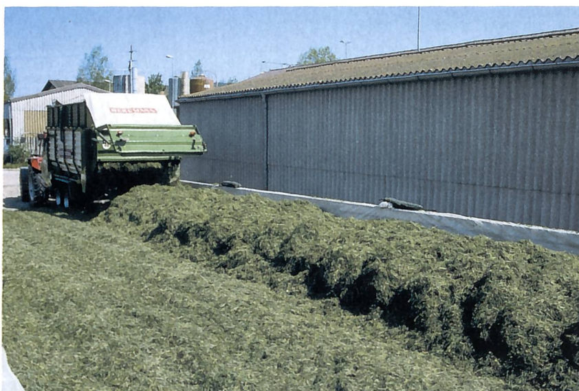
Zum Befüllen von Flachsilos stellen mit Dosierwalzen ausgerüstete Erntewagen die ideale, aber nicht die billigste Lösung dar. Die gute Schnittqualität des Laderotors schafft günstige Voraussetzungen für eine gute Gärqualität im Silo.
