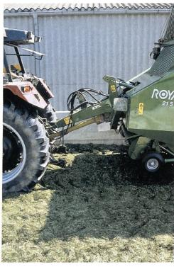
Mit einer Knickdeichsel ausgerüstete Silierladewagen lassen sich Probleme beim Befüllen des Flachsilos vermeiden.
