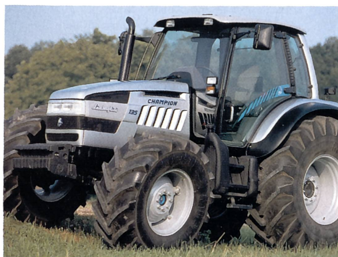
SDF führt konsequent die Mehrmarkenstrategie und nutzt nicht nur beim Design, das Potential deutscher Gründlichkeit und italienischer Raffinesse. Die Lamborghini Champion-Serie (128, 140 und 155 PS) ist ausgerüstet mit dem neuen RISE-Motor (Resonance Intake System Engine) und drei Ventilen pro Zylinder für die Verbrennungsoptimierung. Es werden ein Drehmomentanstieg über 40% und ein Konstantleistungsbereich von 1800–2350 U/min erzielt, bei einem Dieselverbrauch um 200 g/kWh.
