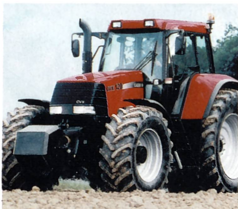
Nach Fendt auch bei Case serienreif: Die CVX- und CVT-Serie zwischen 88 und 125 kW verfügen über ein leistungsverzweigtes Automatikgetriebe mit hochmoderner elektronischer Sensorsteuerung.
