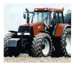
Nach Fendt auch bei Case serienreif: Die CVX- und CVT-Serie zwischen 88 und 125 kW verfügen über ein leistungsverzweigtes Automatikgetriebe mit bochmoderner elektronischer Sensorsteuerung.
