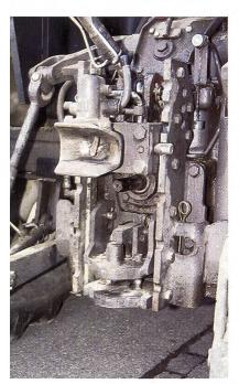
Oben die selbsttätige und höbenverstellbare Anhängerkupplung, unter der Zapfwelle der PITON-FIX mit Sicherheitsklinke.
