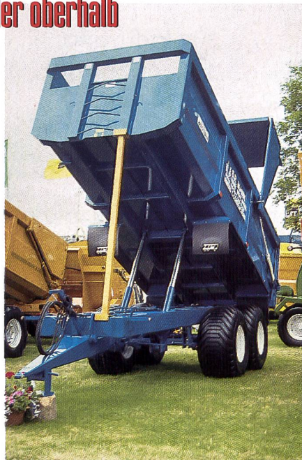
Zum schweren Muldenkipper gehören die Untenanhängung und eine gefederte Deichsel.
