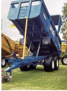
Zum schweren Muldenkipper gehören die Untenanhängung und eine gefederte Deichsel.
