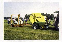
Einzelne Wickler sind so konstruiert, dass sie sich mit wenig Aufwand an jede Rundballenpresse anhängen lassen. Durch die Kombination der beiden Arbeitsgänge Pressen und Wickeln lassen sich ein Fahrer und ein Traktor einsparen, was sich bei Lohnunternehmern in Spitzenzeiten auszahlen kann. Allerdings lassen sich diese Wickelmaschinen nicht solo einsetzen.
