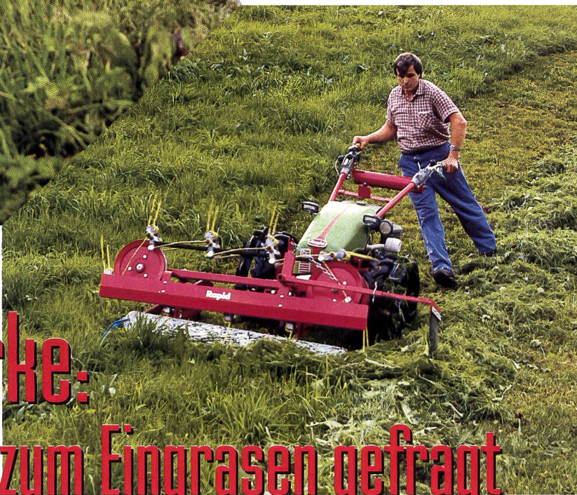
Abb. 2: Der Eingrasmäher ist sehr bodenschonend, aber relativ teuer. Wird er in Zukunft seine starke Position noch halten können?
