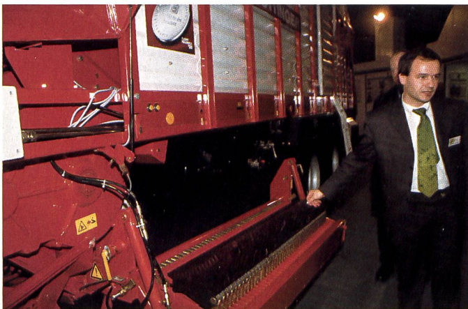
Pöttinger: Ausschwenkbarer Rahmen für den Messerbalken an Grossraum-Ladewagen.
