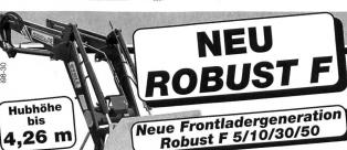
Frontladerschwinge aus Feinkornstahl dadurch mehr Stabilität
