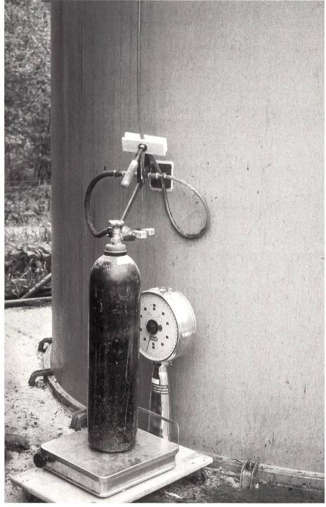
Abb. 11: Injektion von CO₂-Gas in den voll mit nassem Grashäcksel gefüllten Silo. Bei keiner Messung konnte ein Gasdruck von über einem bar festgestellt werden.
