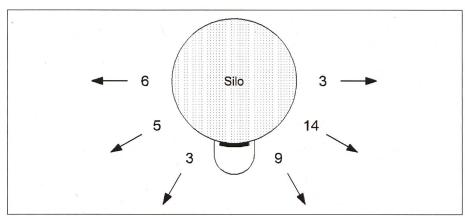
Abb. 5: Entnahmeluke – Sturzrichtung (n = 40). Der Umsturz erfolgte mehrheitlich in Richtung Lukenband.
