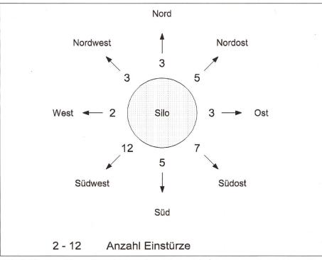
Abb. 7: Siloexposition – Sturzrichtung (n = 40). Die Häufung der Umsturzrichtung Südwest dürfte mehr mit einer vermehrten Ausrichtung des Lukenbandes in diese Richtung zusammenhängen.
