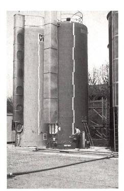
Abb. 8: Links geschleuderter Silo, rechts gewickelter Silo. Die beiden Versuchssilos hatten folgende Abmessungen: h = 10 m, d = 3,5 m, V = 100 m<sup>3</sup>. Alter bei Versuchsbeginn: 7 Jahre.
