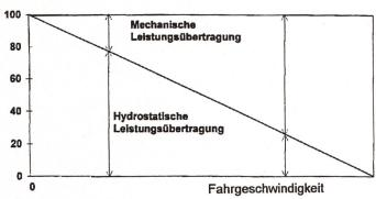
Schema Leistungsverzweigung: Mit zunehmender Geschwindigkeit nimmt der Anteil der hydrostatisch übertragenen Leistung ab. Bei Höchstgeschwindigkeit wird die gesamte Motorleistung über den mechanischen Teil übertragen.
