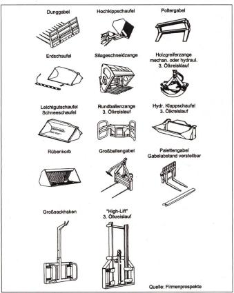
© Auswahl häufig eingesetzter Arbeitswerkzeuge für verschiedene Geräte für den Güterumschlag [1].
