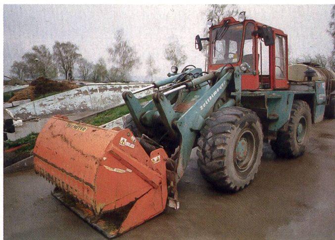
④ Auf den Milchviehbetrieben in Süddeutschland ist der Radlader weit verbreitet. Die schwere Maschine wird zum Befüllen des Fabsilos, zur Futterentnahme mit der Silagezange und zum Befüllen des Futtermischwagens mit Silage und anderen Schüttgütern (z. B. Getreidemischung ab Loselager) eingesetzt.
