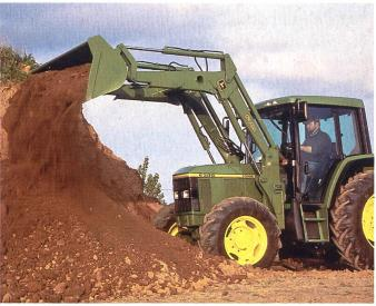
③ Reicht die Hubkraft, so wird der Frontlader zusammen mit den Arbeitsgeräten zu einem der vielfältigsten Werkeuge der innerbetrieblichen Logistik. Wichtig ist, dass der Fahrer in seiner Kabine gegen berunterfallende Lasten geschützt ist.
