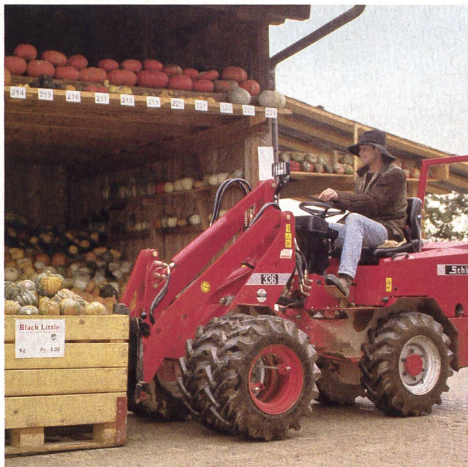
② Hoflader mit Knicklenkung: unübertroffene Wendigkeit und Universalität der Einsatzmöglichkeiten.
