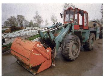
Auf den Milchviehbetrieben in Süddeutschland ist der Radlader weit verbreitet. Die schwere Maschine wird zum Befüllen des Fahrsilos, zur Futterentnahme mit der Silagezange und zum Befüllen des Futtermischwagens mit Silage und anderen Schüttgütern (z.B. Getreidemischung ab Loselager) eingesetzt.
