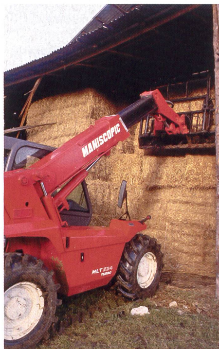
③ Reicht die Hubkraft, so wird der Frontlader zusammen mit den Arbeitsgeräten zu einem der vielfältigsten Werkzeuge der innerbetrieblichen Logistik. Wichtig ist, dass der Fahrer in seiner Kabine gegen herunterfallende Lasten geschützt ist.
