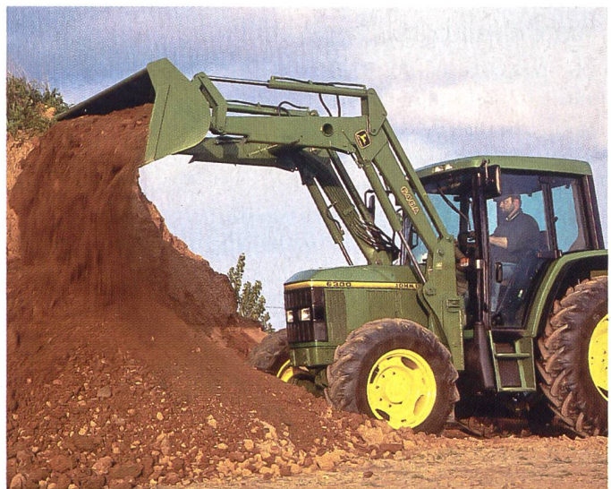
③ Reicht die Hubkraft, so wird der Frontlader zusammen mit den Arbeitsgeräten zu einem der vielfältigsten Werkzeuge der innerbetrieblichen Logistik. Wichtig ist, dass der Fahrer in seiner Kabine gegen herunterfallende Lasten geschützt ist.
