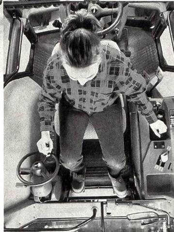
Sobald die Rückfahrvorrichtung gewählt und der Sitz gedreht wird, schaltet sich das vordere Lenkrad samt den entsprechenden Bedienelementen aus Sicherheitsüberlegungen aus. Auch Brems- und Gaspedal sind in zweifacher Ausführung vorhanden. Das Kupplungs-pedal wird lediglich zum Starten des Traktors gebraucht und wird für sämtliche übrigen Kupplungs- und Lastschaltvorgänge nicht mehr benötigt.
