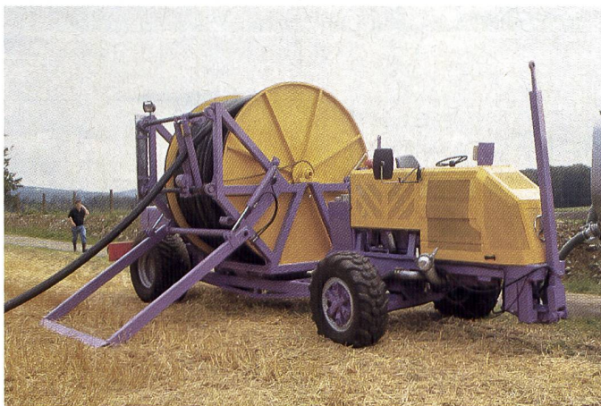
Prototyp einer Schlauchrolle auf Anhängerfahrzeug mit hydrostatischem Fabrantrieb für die Verschiebung am Feldrand. Motorleistung für das Pumpenaggregat 130 PS, Allradlenkung, Funkfernsteuerung, Prototyp der Firma Strebel, Waldbäuser AG.
