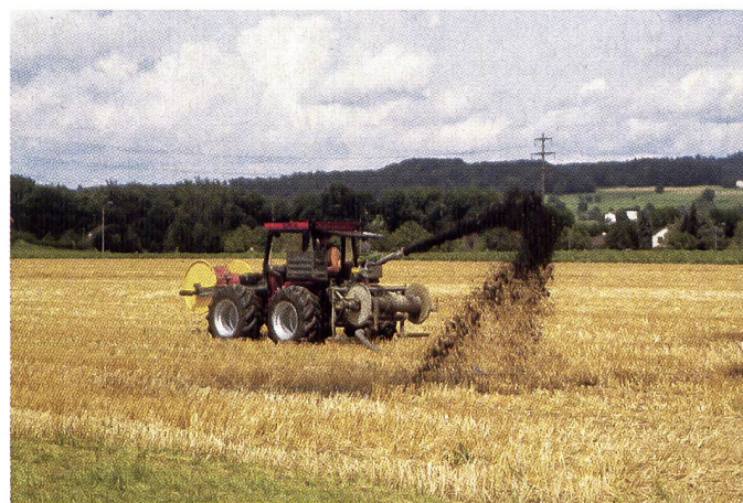
Automatischer Schwenkverteiler auf Carraro Tigrone 7700.
