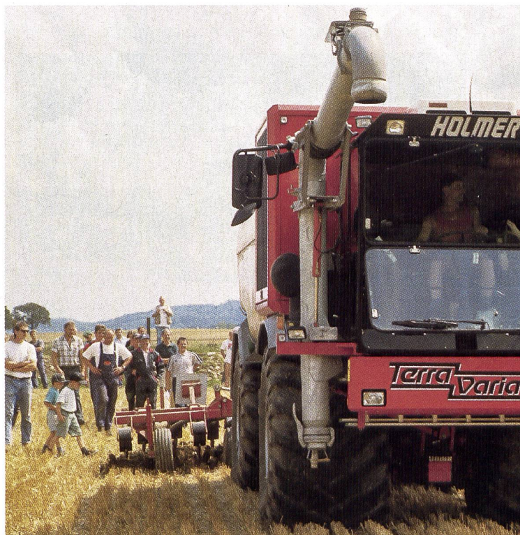
Superlative der Klärschlammausbringung: Selbstfabriker Holmer, Leergewicht 13 Tonnen, normales Arbeitsgewicht 24 t, Reifendruckregelanlage, 420-PS-Motor mit Grubber-Eindrillung 8–12 cm, Bordelektronik für die Ausbringmenge.
