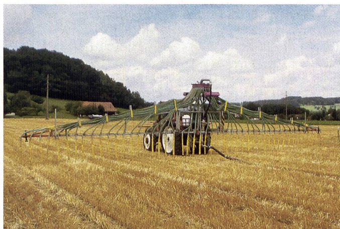
Schleppschlauchverteileranlage Hadorn, Leimiswil BE, Schlauchabstand 30 cm, Arbeitsbreite zwischen 12 und 15 Meter.
