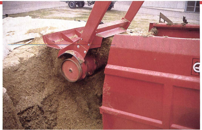
Mit dem Fräsmischwagen lassen sich sehr hohe Entnahmeleistungen realisieren. 200 kg pro Minute sind problemlos möglich. Der Anteil der Rüstzeiten (Silo öffnen, Rangierfahrten, Silage zusammenputzen) ist aber nicht unerheblich.
