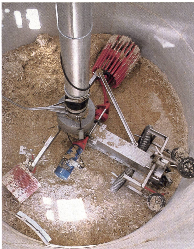
Die Entnahmefräse im Hochsilo bringt Arbeitserleichterung, aber keine grosse Arbeitszeiteinsparung.
