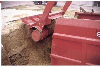
Mit dem Fräsmischwagen lassen sich sehr hohe Entnahmeleistungen realisieren. 200 kg pro Minute sind problemlos möglich. Der Anteil der Rüstzeiten (Silo öffnen, Rangierfahrten, Silage zusammenputzen) ist aber nicht unerheblich.
