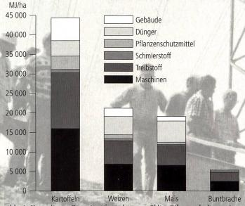
Abb. 1: Kumulierter Energieaufwand ausgewählter Pflanzenkulturen im Vergleich.
