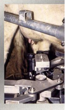
menge sowie das automatisierte Ausmelken und die Melkzeugabnahme bei einem Milchfluss unter 200 ml pro Minute Stand der Technik. Zudem können auch die Melkzeug-Zwischenreinigung und das Dippen der Zitzen vor dem Verlassen des Melkstands automatisiert werden. Vervollkommnung und differenzierte Anpassung der Melkstände an ver-
