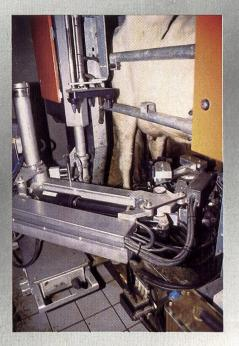
Sensor- und Steuerungstechnik auf höchstem Niveau erfasst die Euterform und die Position der Zitzen, die mit schlafwandlerischer Sicherbeit angesteuert und erfasst werden. System Prolion wendet für die Steuerungstechnik Ultraschallmessungen
