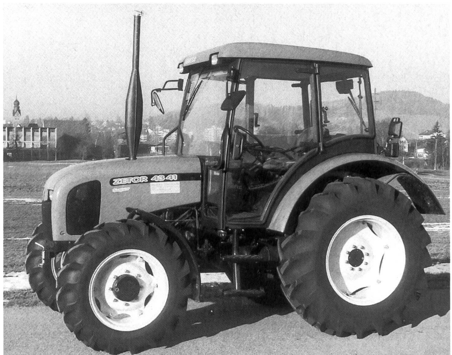
Abb. 11: Traktor ZETOR 4341 Super, 4-Zylinder-Saugmotor mit 44 kW (60 PS), teil-synchronisiertes 5-Gang-Getriebe (Listenpreis Fr. 55 806.-).
