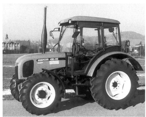
Abb. 11: Traktor ZETOR 4341 Super, 4-Zylinder-Saugmotor mit 44 kW (60 PS), teil-synchronisiertes 5-Gang-Getriebe (Listenpreis Fr. 55 806.–).
