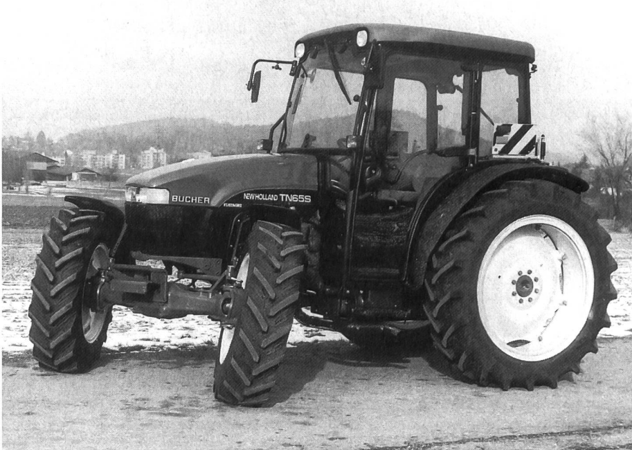
Abb. 2: Die Trakturvorderachse SuperSteer ermöglicht eine Vergrösserung des Lenkwinkels von 55 auf 76°. Der Wendekreis verkleinert sich von 7,9 auf 6,8 m.
