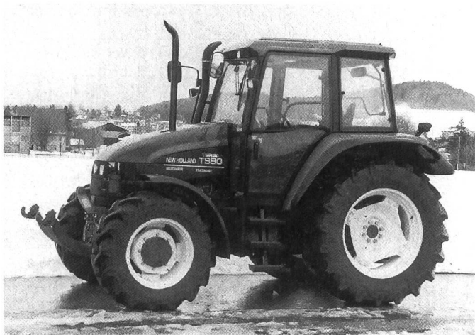
Abb. 7: Traktor NEW HOLLAND TS 90, 4-Zylinder-Turbomotor mit 70 kW (95 PS), 4-Stufen-Lastschaltgetriebe, Fronthydraulik und Frontzapfwelle (Listenpreis Fr. 97 560.-).
