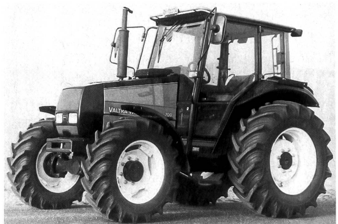
Abb. 6: Traktor VALMET 700-4, 3-Zylinder-Turbomotor mit 51 kW (70 PS), synchronisiertes 4-Gang-Getriebe (Listenpreis Fr. 54 000.-).
