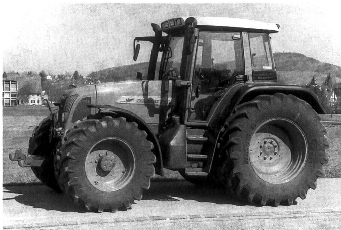
Abb. 5: Traktor FENDT Favorit 716 Vario, 6-Zylinder-Turbomotor mit 118 kW (160 PS), stufenloses Getriebe, Fronthydraulik (Listenpreis Fr. 172 500.-).
