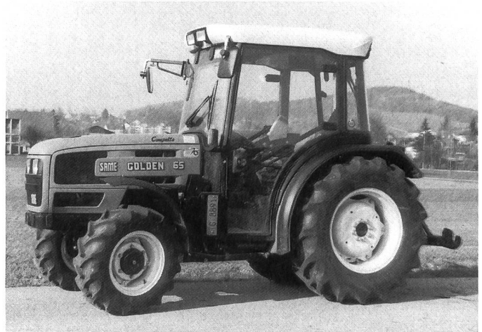
Abb. 10: Traktor SAME Golden 65, 3-Zylinder-Turbomotor mit 48 kW (65 PS), 3-Stufen-Lastschaltgetriebe (Listenpreis Fr. 63 200.-).
