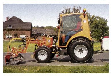
Die hydrostatische Knicklenkung sowie der permanente, stufenlose hydrostatische Allradantrieb (2 Geschwindigkeiten) und 4 Anbauräume des Kleingeräteträgers TS COMPACT 150 GT bieten überlegene Wirtschaftlichkeit im Winter- und Sommerdienst sowie für Bodenbearbeitungsarbeiten. Eine Normzapfwelle vorne, zwischenachsig und hinten (elektrohydraulisch lastschaltbar) sowie variable Spurbreiten (schmalste Breite 1200 mm) sind für unzählige Anbauvarianten und Einsatzgebiete bestimmt.
