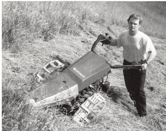
Die neue BUCHER R3 Baureihe in Modulbauweise besteht aus 5 Modellen in drei Stärkeklassen. Die startfreudigen und laufuhigen Kubota-Motoren mit 8,9 und 11 PS garantieren für gutes Drehmoment und lange Lebensdauer. Serienmäßig mit Wendegtriebe, zu schalten ohne den Holm loszulassen, mit 3 Vor- und 3 Rückwärtsgängen.
