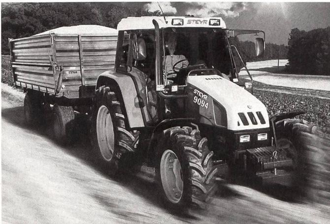
der Baureihe M 900 (68 und 75 PS) lassen sich jetzt auch Allrad- und Differentialsperre jederzeit unter Last elektrohydraulisch zuschalten.
