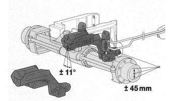
gefederte Vorderachse (Federung sperrbar)
