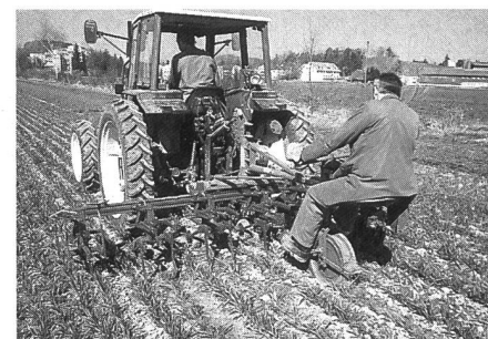
Abb. 11: Hackgeräte entwurzeln und zerschneiden Unkräuter effektiv. Sternhackgeräte verstopfen nicht...
