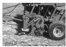
Abb. 5: Die Direktsaat mit Meisselscharen reisst eine Saatfurche auf und läuft nicht Gefahr, Stroh in den Saatschlitz zu pressen. Sie ist aber verstopfungsanfälliger als der Einsatz von Scheibenscharen.
