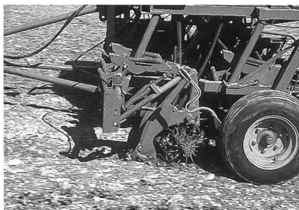
Abb. 5: Die Direktsaat mit Meisselscharen reiss eine Saatfurche auf und läuft nicht Gefahr, Stroh in den Saatschlitz zu pressen. Sie ist aber verstopfungsanfälliger als der Einsatz von Scheibenscharen.
