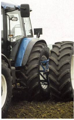
Asymetrische Stollenform: Für einen besseren Selbstreinigungseffekt und mehr Stabilität, aber auch als Desgin-Element des Goodyear-Reifens.
