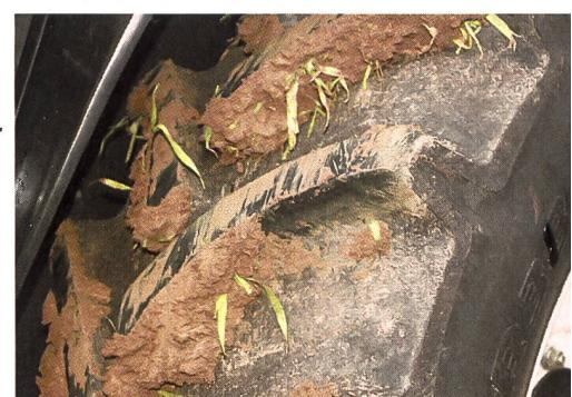
schnittreifens mit einer gleichmässigen Verteilung der Belastung auf eine grosse Aufstandfläche verringert sich die Gefahr von Bodenverdichtungen.
