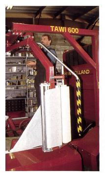
Finish an einer Rundballenpresse. Der geniale Konstrukteur in der Nachbarschaft hat sie mit einem Ballenwickelaggregat aufgerüstet.
