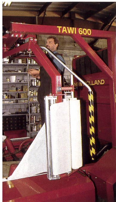
Finish an einer Rundballenpresse. Der geniale Konstrukteur in der Nachbarschaft hat sie mit einem Ballenwickelaggregat auferüstet.
