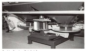
Precision farming, die technische Antwort auf das doppelte Ziel der Kosten-Nutzen-Optimierung und der Umweltschonung, am Beispiel der Schleuderdüngerstreuer. Permanente Dosierungsregulierung (z. B. bei Sulky und bei bogballe), die Umkehr der Drehrichtung der Schleuderscheiben zur Optimierung des Streubildes am Feldrand.
