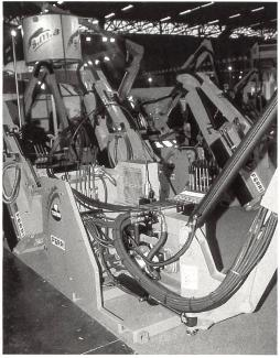
Raffinierte Kombination: Schaufelbagger, verschiebbar mit dem Paletten-Rolli, vorgeseben für Dreipunkt-Hydraulik und den Zapfwellenantrieb des separaten Hydromotors.
