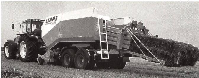
Die neue QUADRANT 2200 bietet das bewährte Ballenmass  $1,20 \times 0,70 \text{ m}$ . Mit einem völlig neuen Kraftstrang, neu konstruierten Pressrahmenaufbau und dem komfortablen CLAAS-Controll-Terminal erreicht diese Maschine mehr Durchsatzleistung und mehr Pressdichte.
