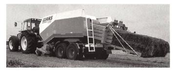
Die neue QUADRANT 2200 bietet das bewährte Ballenmass 1,20×0,70 m. Mit einem völlig neuen Kraftstrang, neukonstruierten Pressrahmenaufbau und dem komfortablen CLAAS-Controll-Terminal erreicht diese Maschine mehr Durchsatzleistung und mehr Pressdichte.
