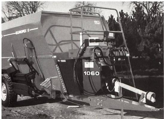
*Die neue programmierbare Wiegeeinrichtung erlaubt die Kalkulation von 15 Rationen mit maximal 15 Komponenten. Ein separates Fabrgestell sorgt bei allen KUHN-Futtermischwagen für besonders hohe Wiegegenauigkeit.*
