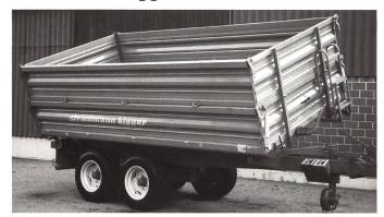
Bei Rapid Maschinen und Fahrzeuge AG aus Dietikon steht auf Saisonbeginn hin ein umfassendes Kipperprogramm von Strautmann bereit. Die Vorzüge ergeben sich aus der Verwendung von hochstehenden Materialien und jahrzehntelanger Erfahrung im Landmaschinenbau, durch die solide Bauweise und die praxisbezogene, bedienungsfreundliche Ausrüstung. Zahlreiche Sonderaus-
