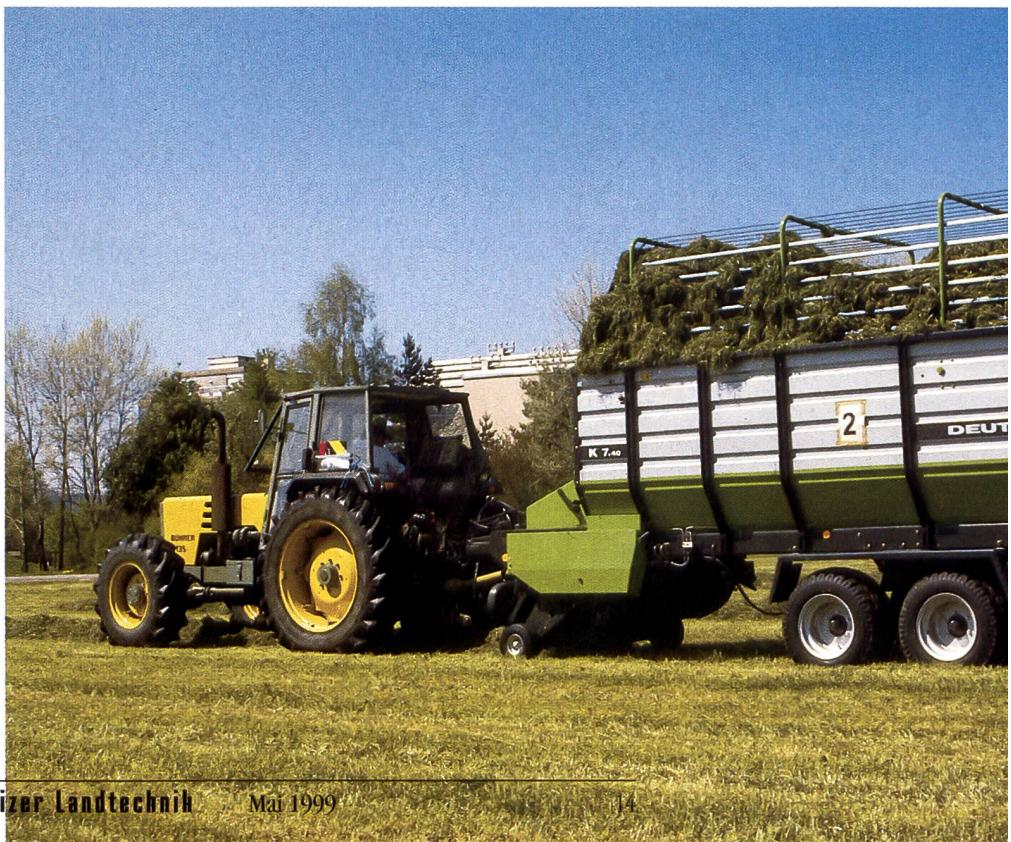
Der Förderrotor wird in Silierladewagen mit hoher Messerzahl wieder vermehrt eingebaut.
