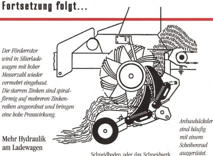
Die hydraulische Pickup-Aushebung ist seit Jahren Standard. Bei mittleren und grösseren Ladewagen wird in der Regel auch der Kratzboden hydraulisch angetrieben. Hat der Ladewagen keine eigene Hydraulikanlage, hängt der Kratzbodenvorschub von der Leistung der Traktorhydraulik ab. Schnellentleerung heisst dann meistens Abladen mit Vollgas. Schwere
