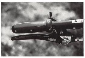
Totmannschaltung am Motormäher für noch mehr Sicherheit. Bild: M. Jutzeler.
